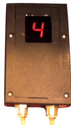
Il visualizzatore di posizione è adatto per le battute 6M,6VM, 8M, 8VM e per le 12M e 12VM. E' una soluzione semplice per la visualizzazione della posizione, adatto per macchine sprovviste di CN.
